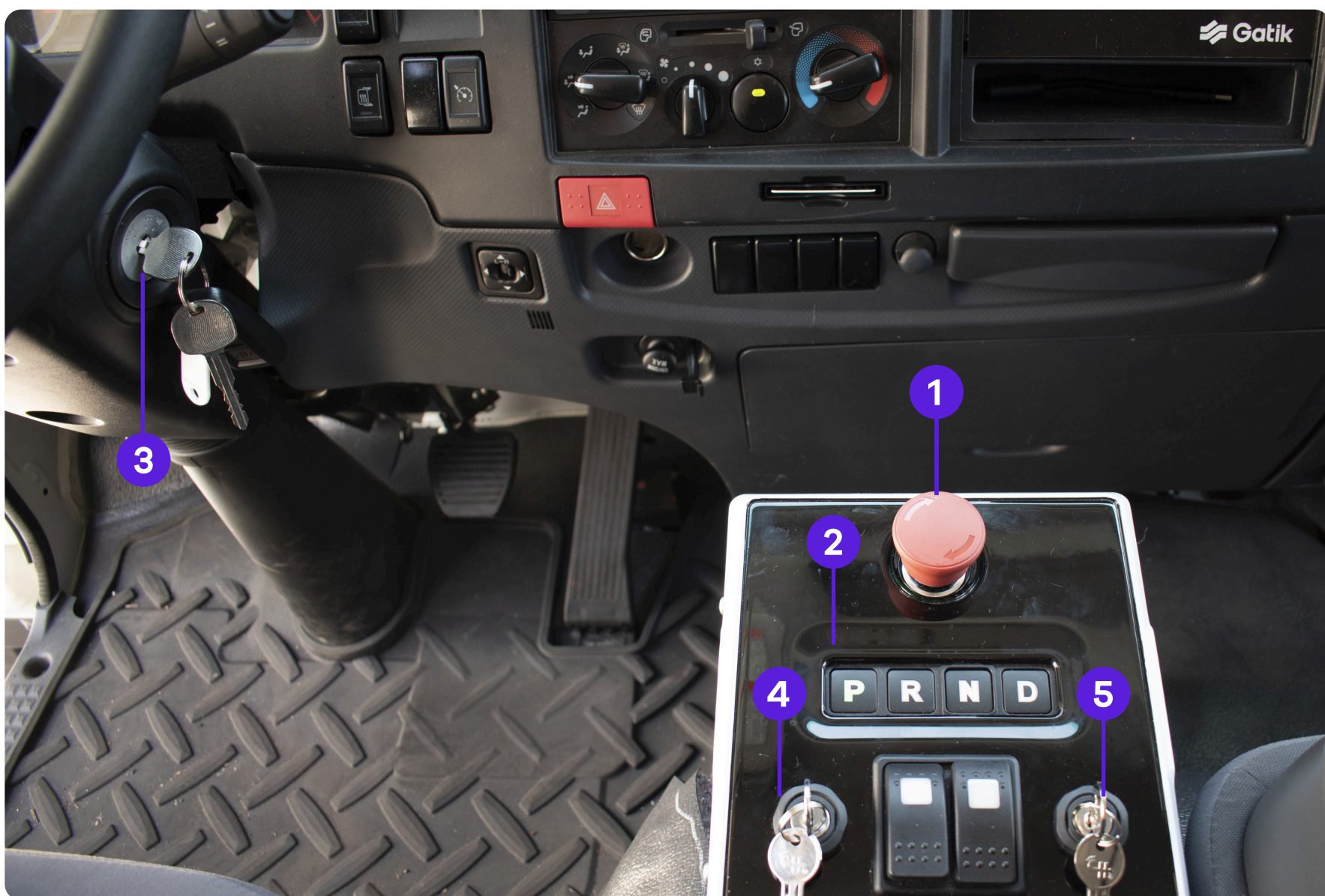
Figure: Emergency-Stop button inside cabin of Gatik AV
